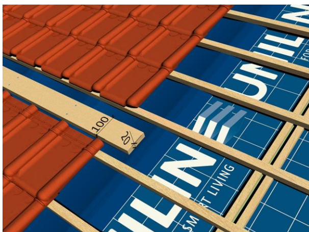
Figure 2 : dimensions des lattes transversales
