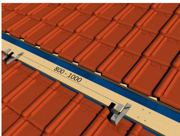
Figure 3 : illustration de la distance entre les crochets de fixation
